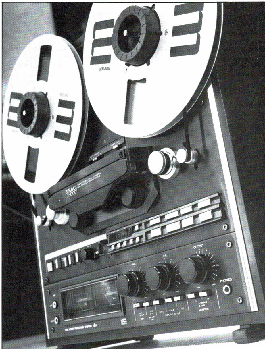
Afb. 11. De voordelen van de spoelenrecorder: hoge bandsnelheid, brede bandsporen (2-spoor kwalitatief te prefereren), geen Dolby nodig, montagemogelijkheid, robuuste structuur, regelbare echo d.m.v. bandsnelheidsvariatie, lange speelduur.
