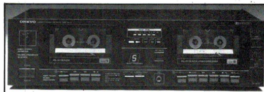
Afb. 13. Het autoreverse dubbeldeck maakt naast een ideale kopieermogelijkheid ook een viervoudige speelduur mogelijk. Begrijpelijk dat dit eigentijdse apparaat zo snel terrein wint.
